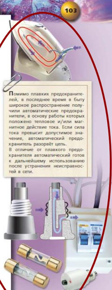
Помимо плавких предохранителей, в последнее время в быту широко распространение получили автоматические предохранители, в основу работы которых положено тепловое и/или магнитное действие тока. Если сила тока превысит допустимое значение, автоматический предохранитель разорвёт цепь. В отличие от плавкого предохранителя автоматический готов к дальнейшему использованию после устранения неисправностей в сети.
