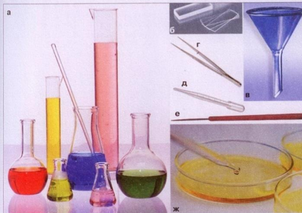
Рис. 4. Лабораторная посуда и оборудование: колбы и мерные цилиндры (а); предметные стёкла (б); воронка (в); пинцет (г); пипетка (д); препаровальная игла (е); чашка Пётри (ж).
